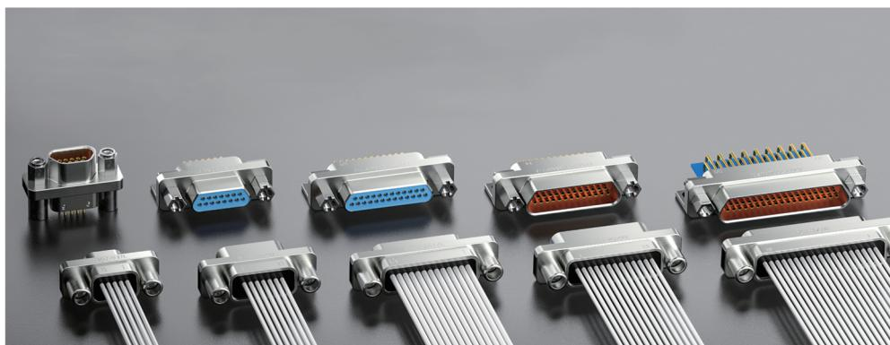
体积约为标准D形连接器的50%，触点间距1.27mm，拥有9、15、25、37芯可供选择。两侧设有螺钉结构，连接稳定。端子采用绞线式插针设计，接触稳定。额定电流1A至3A，额定电压300V至500V。
