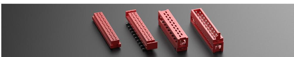
端子采用弹性结构设计，可吸收环境振动，减少插针对触点的摩擦。触点间距1.27mm，有4、6、8、10、12、14、16、18、20位数可选。阻燃性等级达UL94 V-0，并提供通孔焊接、IDC和表面贴装三种安装方式。
