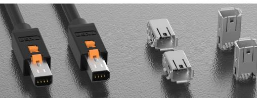
符合IEC 61076-3-122标准，体积仅为标准RJ45连接器的25%。双头接触式簧片结构，触点间距仅1.27mm。插头设屏蔽层结构，可屏蔽EMI/RFI干扰。传输带宽支持100Mbps (Cat5e) 到1000Mbps (Cat6A)，提供D形、U形两种接口类型。
