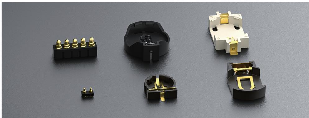
纽扣电池座的主体采用耐高温工程塑料，具有耐温、抗腐蚀，耐冲击等特点。顶针式电池座采用弹簧探针设计，支持10000次插拔循环。产品高度与弹簧力可进行定制。
