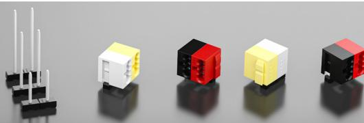
符合EN/IEC 60998-2-2标准，采用夹持弹簧结构，导线剥线后可直接插入接线口。AWG22号导线（导体截面积0.34mm<sup>2</sup>），电流7A，电压150V。AWG18号导线（导体截面积0.75mm<sup>2</sup>）电流9A，电压130V。配套排针，针长有9.6mm、16.6mm、23mm、25.1mm等多款可选。
