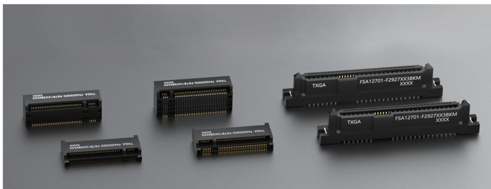
M.2连接器中心间距为0.5mm，高度有3.2至8.5mm可选。PCIe连接器中心间距为1mm，传输速率为16GT/s和32GT/s。Mini PCIe连接器数据传输率达4Gb/s。SAS连接器符合SAS 4.0技术规范，传输速率达24Gb/s。DDR连接器最高带宽为3200MHz至6400MHz，满足多场景的应用需求。
