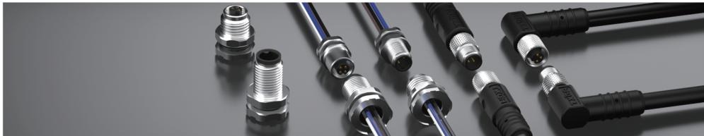
符合IEC 61076-2-105标准，拥有直头和弯角带电缆连接器。外螺纹直径仅5mm，易于小型化设备安装布局。防护等级达IP68，有2芯、3芯和4芯可供选择。
