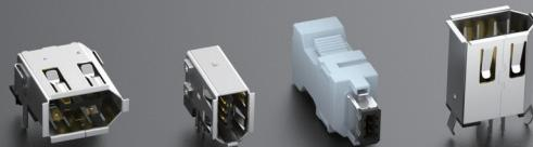
采用六线传输结构，数据传输达400Mbps，支持为外部设备提供电源供电。位数为6，电流1A至1.5A，电压30V至40V。材料阻燃等级达UL94 V-0，支持热插拔。
