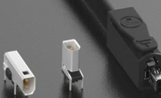
符合IEC 63171-2 (IP20) 标准，体积仅为标准RJ45连接器的20%。线缆设有双屏蔽层，可有效减少信号干扰。额定电流4A，额定电压72V，有90°、180°板装插座及带线插头型号可选。输距离40米，传输速率1Gbit/s；传输距离1000米，传输速率10Mbps。
