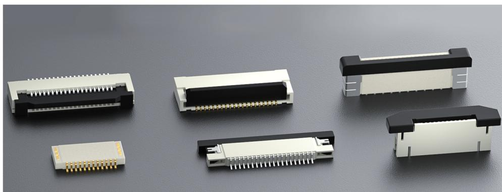
中心间距提供有0.3、0.5、1、1.25mm，位数提供4至68位。电流0.2A至1A，电压25V至50V。连接方式有后掀锁、前掀锁、抽锁和无锁四种可选，更好的解决了FPC安装问题，使操作性和可靠性得到了大幅的提高。
