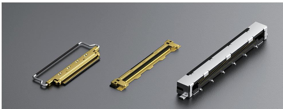
中心间距0.5mm，位数提供有30、40和51位。额定电流0.5A，电压50V至100V。安装方式有表面贴装和焊线，卧贴高度仅3.75，体积小，可节省PCB空间。
