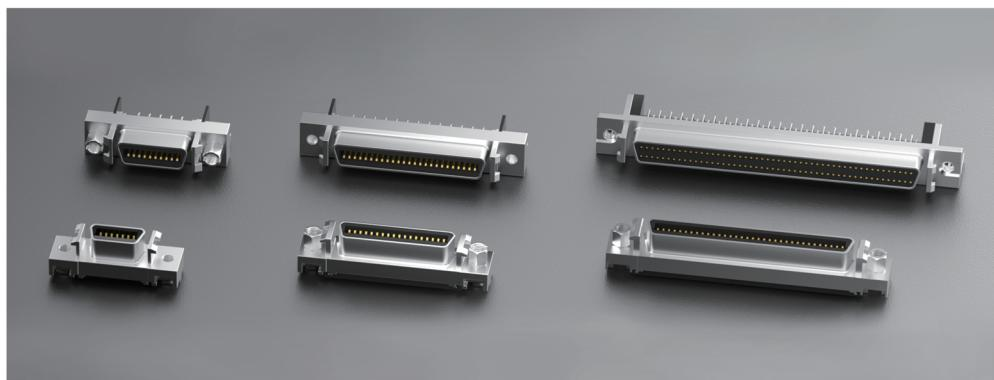
支持多个外设同时工作，传输速率可达10MB/s。支持热插拔功能，方便更换设备。每触点最大电流为1.00A，最大电压为250V，触点间距仅1.27mm。拥有14、20、26、36、40、50、68、100芯可供选择。
