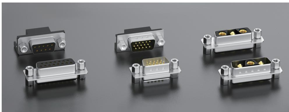
支持高低频混装、大电流和高密度的设备互联。公母座对插有免打螺丝锁紧结构和螺丝锁紧结构，牢固可靠。有单排、双排、三排、四排，同时提供1至78位数可选。安装方式有通孔焊接、IDC、铆接式、焊线等四种。
