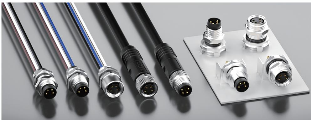
符合IEC 61076-2-105标准，防护等级为IP65/68。拥有屏蔽型与非屏蔽型，屏蔽型产品可有效减少EMI、RFI干扰，确保信号传输的稳定性与可靠性。额定电流1.5A至4A，额定电压30V至63V，有A、B、D编码可选，并提供通孔焊接与焊线两种安装方式。
