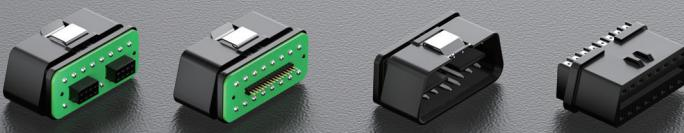
符合SAE J1978汽车诊断协议规范，产品材料阻燃等级达UL94 V-0。设有弹片结构，对插稳定。OBD设备外壳可直接扣入槽内，组装更便捷。拥有母插头、公插头、公插头焊板、OBD公头转OBD母头、OBD公头带弹片转OBD母头、OBD公头转DB15双排母头六款可供选择。
