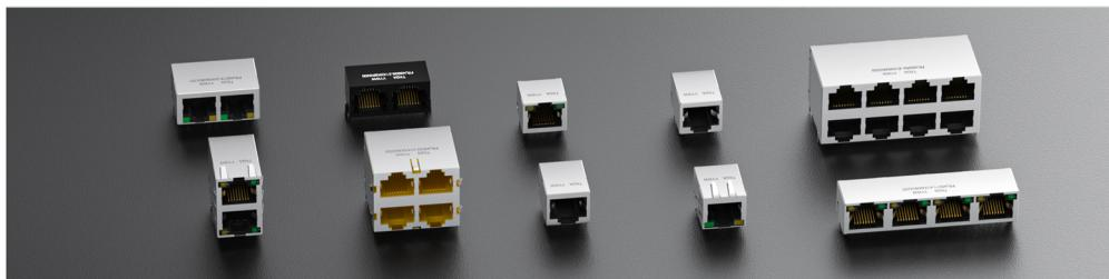
符合以太网IEE802.3设计标准，支持CAT5e。产品具有屏蔽和非屏蔽，可屏蔽EMI/RFI干扰。内设有电气模组，能够稳定输出电压。端口配置提供单口、双口、四口、八口，安装方式提供顶部进入、侧面进入、沉板式。
