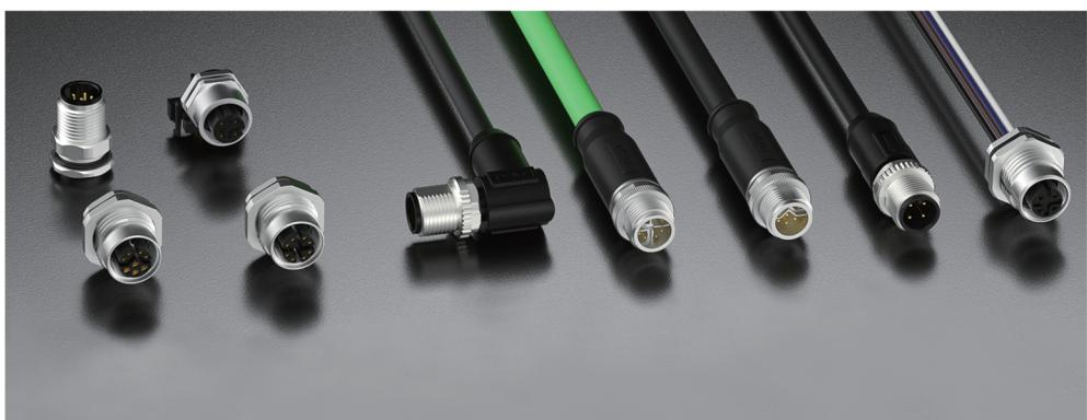
M12圆形连接器系列防护等级为IP67/IP68，可屏蔽EMI/RFI干扰。额定电流0.5A至6A，额定电压30V至250V，有A编码、B编码、D编码、X编码、Y编码可选。可提供多种接线方式，通孔焊接、螺钉固定、焊线。
